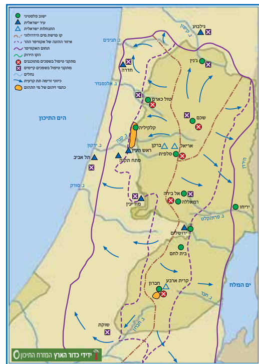
מפת אקוות הרה, עם סימון אזור ההזנה והאזור הכלוא, כונוני הזרימה, אזורי זיהום נרחב במי התהום ומתקני טיפול בשפכים קיימים (ובהקמה) ומתוכננים
